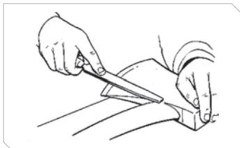
**Quando apenas uma das mãos segurar a lima:** Para limar peças que não estão presas a um torno ou a uma morsa, geralmente o dedo indicador é colocado sobre o cabo, em linha com a lima.
